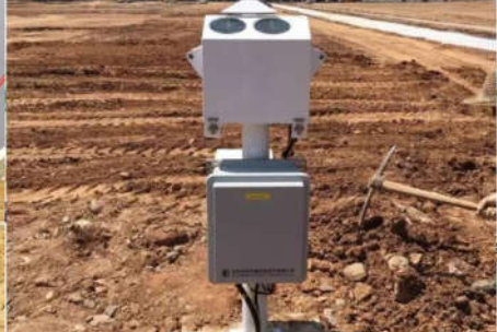
设于跑道中线延长线上的云高仪
