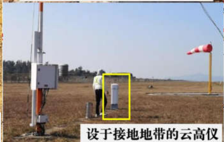
设于跑道中线延长线上的云高仪
